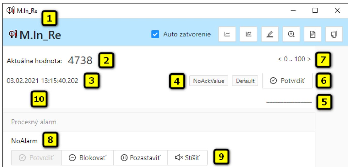
Ako už bolo spomenuté, titulok okna obsahuje názov ovládaného objektu (1). Vrchná as okna obsahuje aktuálnu hodnotu (náhradnú hodnotu) objektu (2) s polu s technickými jednotkami, as priradenia hodnoty (3) a stavu hodnoty (4).
