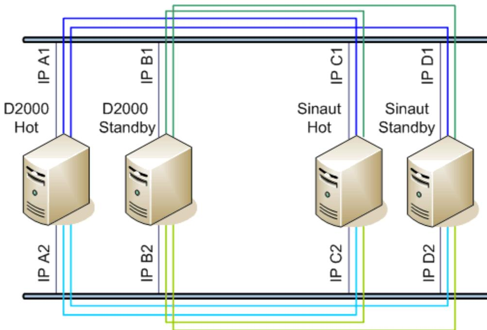
Obrázok znázorňuje TCP spojenia - každý proces **D2000 KOM** (D2000 Hot, D2000 StandBy) s každým Sinaut-om (Sinaut Hot, Sinaut StandBy).
