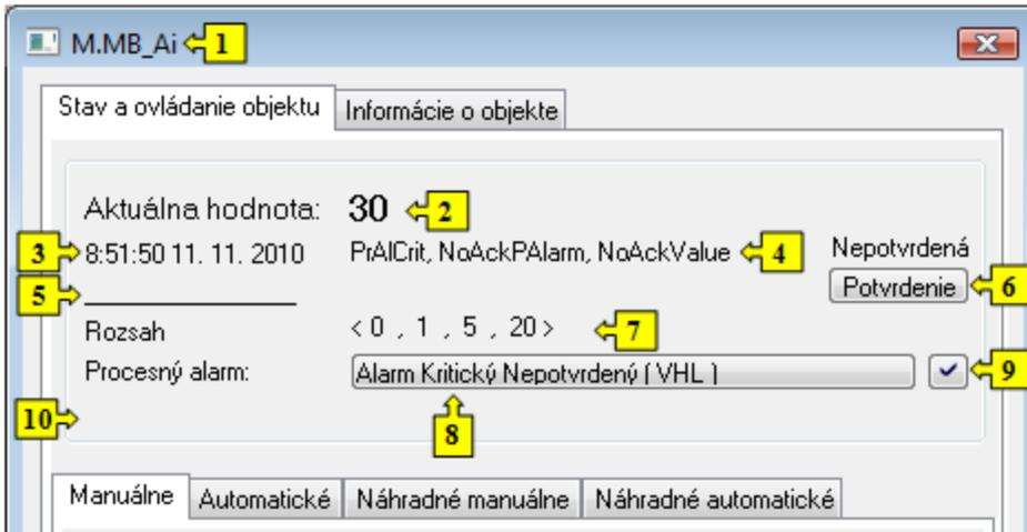
Ako už bolo spomenuté, titulok okna obsahuje názov ovládaného objektu (1). Vrchná as okna obsahuje aktuálnu hodnotu (náhradnú hodnotu) objektu (2) s polu s technickými jednotkami, as priradenia hodnoty (3) a [stavy hodnoty](#) (4).
