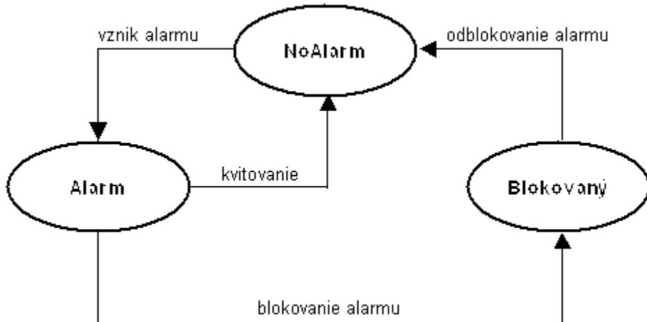
Po vzniku alarmovej podmienky sa nastaví v hodnote daného objektu *príznak alarmu*, *príznak nepotvrdenia alarmu* a *typ alarmu*, ktorý vznikol. Po potvrdení (kvitovaní) alarmu sa obidva príznaky zrušia a typ alarmu sa nastaví na **NoAlarm**.
