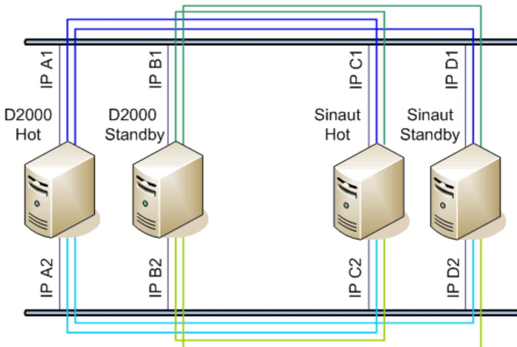
Obrázok znázorzuje TCP spojenia - každý proces **D2000 KOM** (D2000 Hot, D2000 StandBy) s každým Sinaut-om (Sinaut Hot, Sinaut StandBy).
