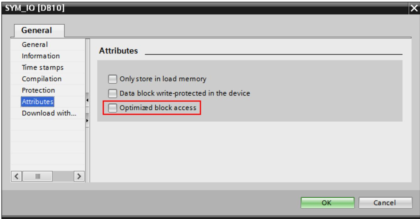
Po zmene bezpečnostných nastavení v TIA Portal je nutné v menu vybrať Compile "Software (Rebuild all)" a po skompilovaní projekt nahrá do PLC. iastoný rebuild nemusí postačovať.
