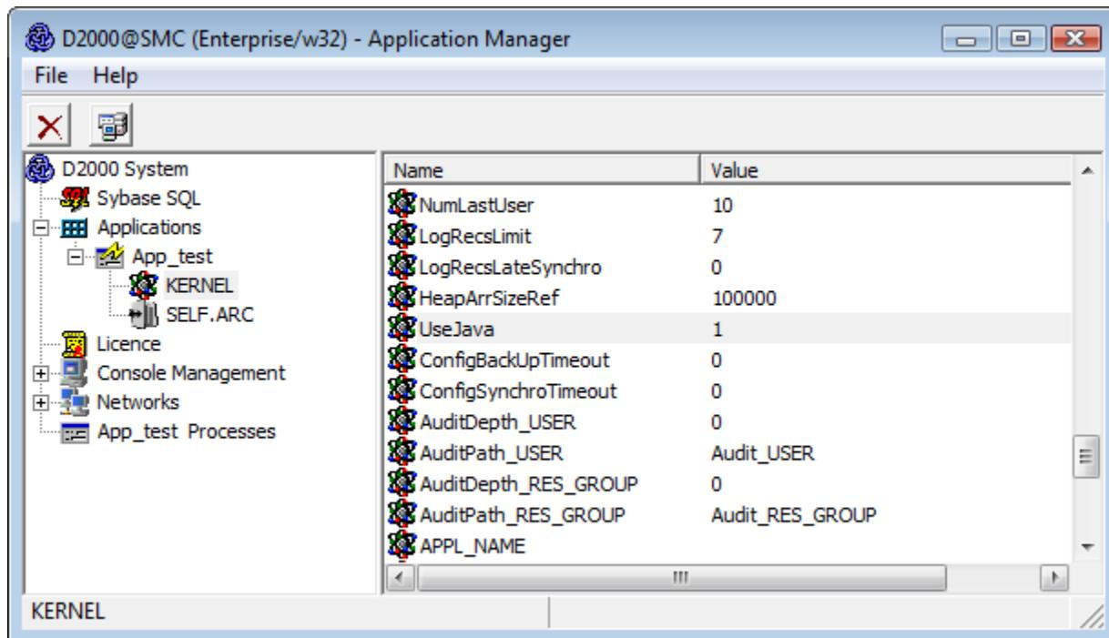
Toto nastavenie spôsobí, že systém D2000 bude generova wrappery pre objekty D2000 a umožní beh Java skriptov v **schémach** a **eventoch**. Z toho vyplývajú vyšše nároky na pamäť a procesor. Nastavenie je potrebné urobi na počítači, kde beží proces **D2000 Server**, v prípade **redundantného systému** na všetkých počítačoch, kde bežia servery tvoriace redundantnú skupinu.
