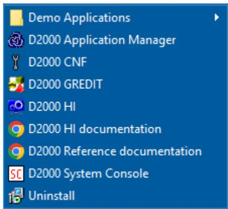
Pokiaľ je spustený D2000 Application Manager, procesy D2000 HI a D2000 GrEditor je možné spustiť priamo z toolbaru kliknutím na ikonky s tooltipmi "Start GR" a "Start HI".
